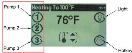
Wenn Sie einmal auf die Taste „Jets 1“ (Pumpe 1) drücken, fährt die Pumpe auf langsamer Geschwindigkeit. Wenn Sie ein zweites Mal drücken, fährt sie auf schnelle Geschwindigkeit hoch. Drücken Sie ein drittes Mal, schaltet die Pumpe ab.
