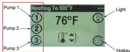
Drücken Sie die entsprechende Taste einmal, um Pumpe 2 oder 3 einzuschalten. Jede läuft unabhängig und ermöglicht Ihnen flexible Kontrolle über die Wassermenge, die durch die Schwimmbadpumpen fließen soll. Wenn Sie einer der Tasten ein zweites Mal drücken, schaltet die jeweilige Pumpe ab. Ein integrierter Zeitmesser schaltet die Pumpe(n) ab.
