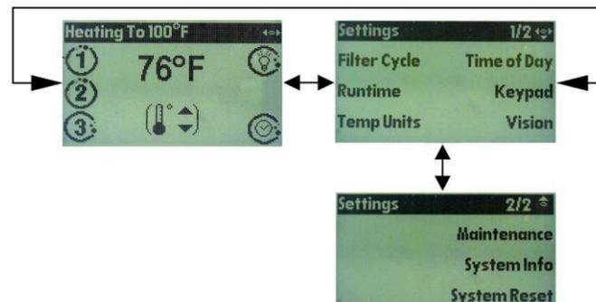
Das Temperatur- und Einstellungs-menü sind die zwei Hauptmenüs der Bedienkonsole. Mit dem Temperaturmenü wird die Schwimmbadtemperatur eingestellt und schaltet die Strahlpumpe ein und aus und betreibt die Schwimmbadbeleuchtung. Das Einstellungs-menü regelt weitere verschiedene Funktionen des Schwimmbades einschließlich Tageszeit und Helligkeit der Anzeige.
